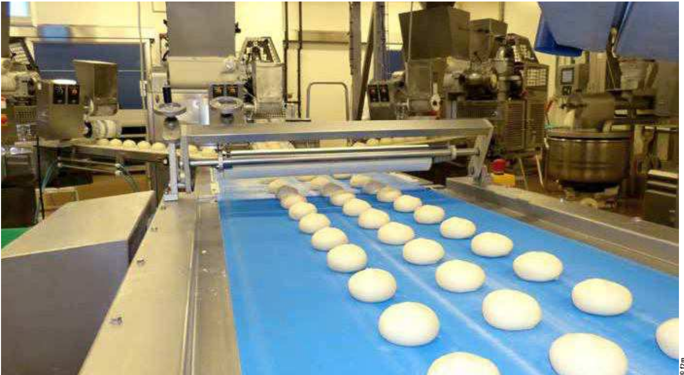
++ Drei Rheon-Anlagen bringen die verschiedenen Füllungen in die Teiglinge
