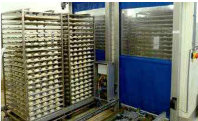
++ Jeweils zwei Stikkenwagen fahren automatisch für 60 Minuten in den Gärraum
