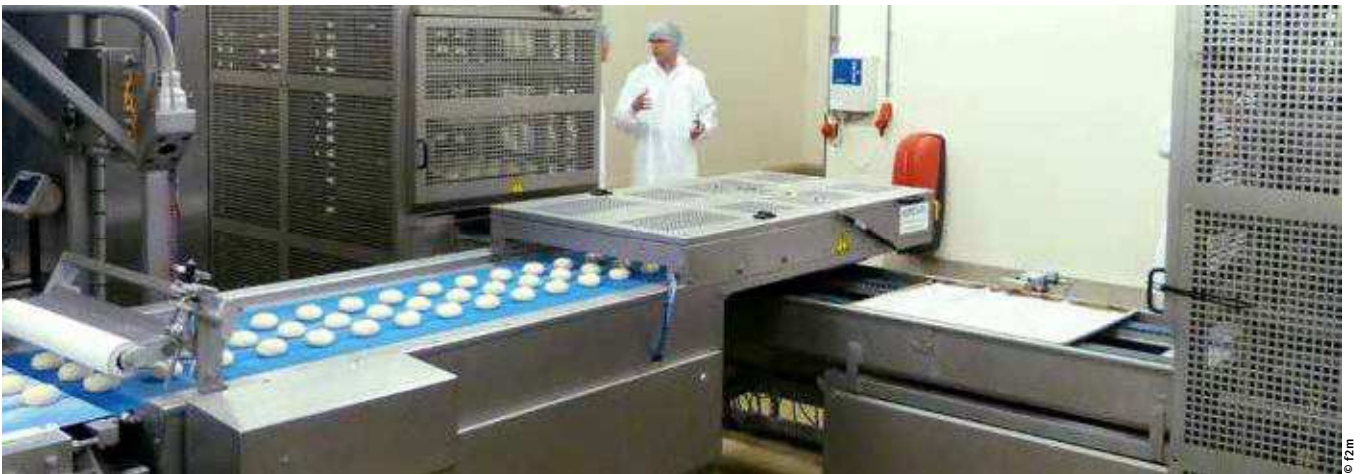
++ Die gefüllten Teiglinge werden auf Bleche abgesetzt. Die Zu- und Abführung erfolgt automatisch. Das gesamte Projekt hat die Firma Kortlever entworfen
